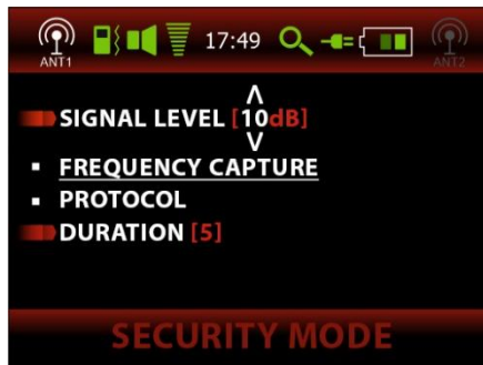
Fig.19 – Cambio del nivel de señal del umbral relativo para la activación de la alarma
