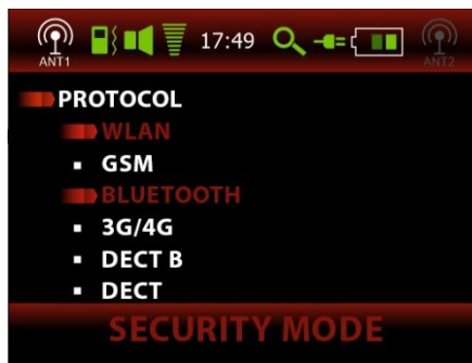
Fig.20 – Inclusión de protocolos seleccionados por separado en la lista de eventos de alarma
